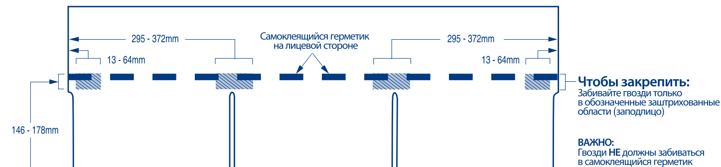
Схема крепления четырьмя гвоздями Размеры битумной черепицы 337-1000 мм.
